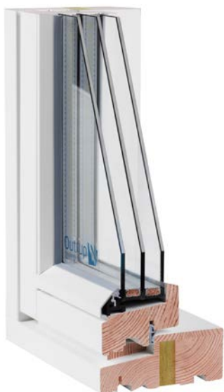
Outrup introducerer i samarbejde med Rockwool® 3-lags energivinduer med isolerede karme, der lever op til BR 2020.
